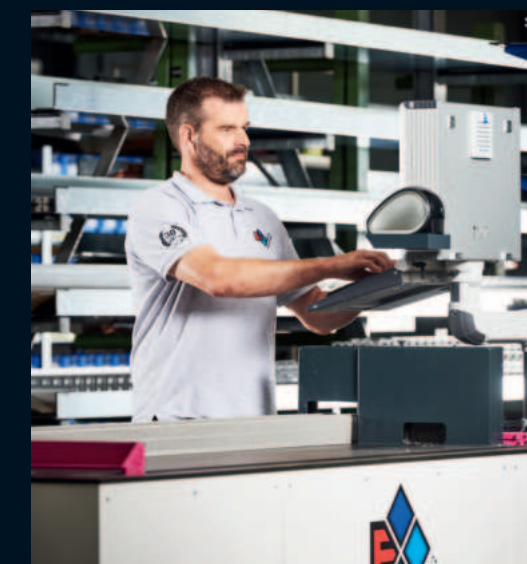
Die Secarex AC 15 für das Ablängen von Verdrahtungskanälen, Kabelkanaldeckeln und Tragschienen.
