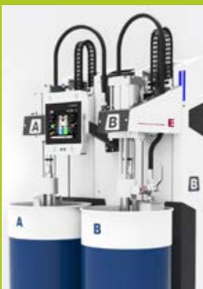
Le système de dosage Top 500P pour le dosage LSR et le traitement du silicium fluide ne nécessite pas d'armoire de commande, grâce à la compacité du système de contrôle S-DIAS et du système d'E/S. Une expérience utilisateur unique est fournie par l'IHM «flottante», qui peut être exploitée de manière intuitive et placée de manière flexible.
