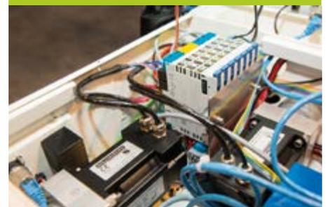
Même à l'intérieur confiné de l'AGV PackMan 200, il y a de la place pour le système S-DIAS anti-vibrations avec Motion Control et Safety, ainsi que pour deux servomoteurs CC basse tension AKM.
