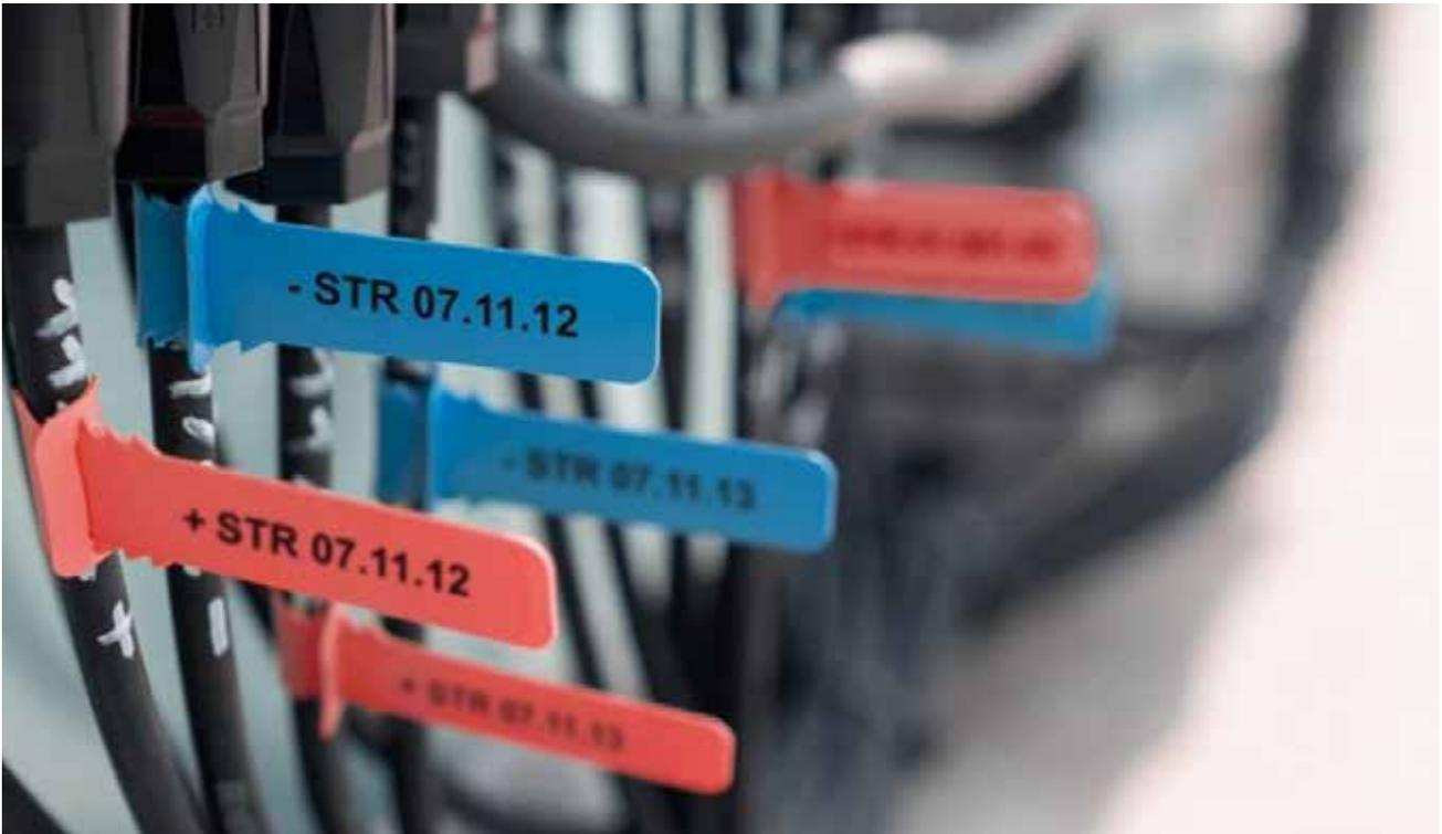
TAGPU LOOP sind bedruckbare Kennzeichnungsschilder zur Markierung von Leitungen und Kabeln ohne Verwendung eines Kabelbinders. Sie werden auf Kabel und Leitungen von 2,8 mm bis 8 mm geschlauft, wo eine dauerhaft lesbare und UV-beständige Markierung erforderlich ist. Die Kabelmarkierer bestehen aus flexiblem und widerstandsfähigem Polyurethan und eignen sich besonders für raue Umgebungen.
