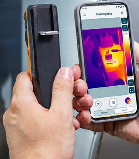
Einfache, schnelle Ermittlung von Delta und Hotspots im Wärmebild
