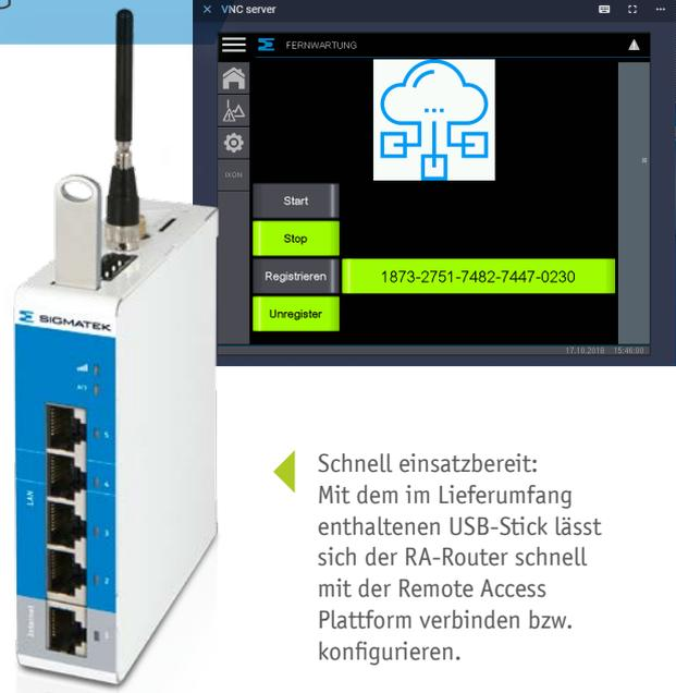
◀ Schnell einsatzbereit: Mit dem im Lieferumfang enthaltenen USB-Stick lässt sich der RA-Router schnell mit der Remote Access Plattform verbinden bzw. konfigurieren.
