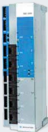
6 Antriebsregler sind bei dieser Serie in einem äußerst kompakten Gehäuse verpackt. Die DIAS-Drives 1000 sind prädestiniert für Roboterapplikationen sowie Anwendungen mit koordinierten Achsen mit unterschiedlicher Dynamik. Neben dem Gehäuse teilen sich die Antriebsregler einen Controller, Zwischenkreis und Kühlkörper – das spart Platz und Kosten.
