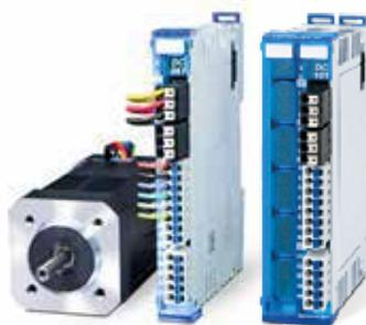
Mit den Achsmodulen DC 061/101 (Resolver) und DC 062/102 (Inkrementalgeber) steht volle Servofunktionalität im Hutschienenformat zur Verfügung. Die Leistungsstufen sind in das Steuerungs- und I/O-System S-DIAS eingebettet und bieten 300 – 480 Watt Nennleistung, einen 2-kanaligen Enable-Eingang zur Realisierung eines STO sowie einen +24 V DC Ausgang zum Ansteuern einer Haltebremse.
