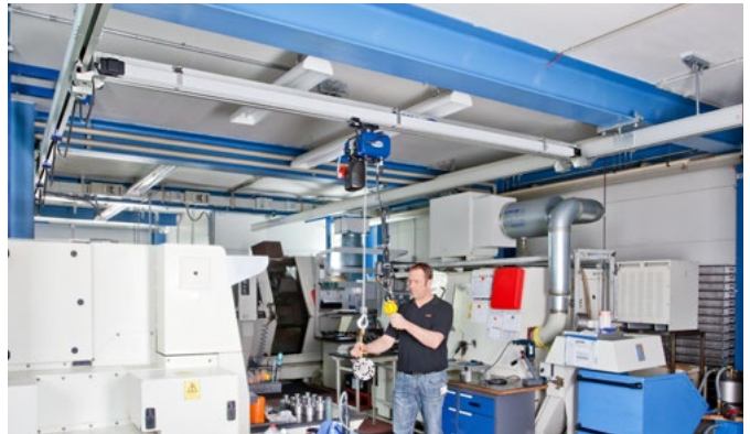
Aluminium-Einträgerkrananlage mit Schleifleitung und Aufbockung zur Reduzierung der Bauhöhe
