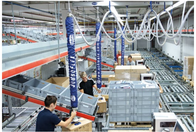
Aluminium-Mehrträgerkrananlage mit Vakuum-Schlauchheber JumboFlex bei der Kommissionierung von Paketen
