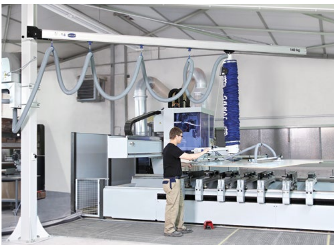
Aluminium-Säulenschwenkkrane mit Vakuum-Schlauchheber JumboErgo bei der Beladung eines CNC-Bearbeitungszentrums
