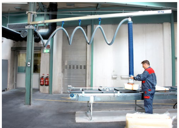
Aluminium-Wandschwenkkrane, montiert an einer Hallensäule, mit Vakuum-Schlauchheber JumboSprint bei der Handhabung von Rohgummiballen
