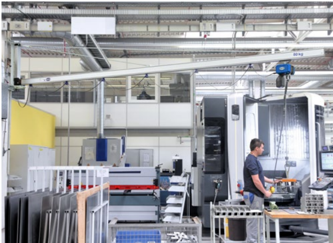
Aluminium-Wandschwenkkrane mit Kettenzug und Magnet bei der Beladung einer Fräsmaschine
