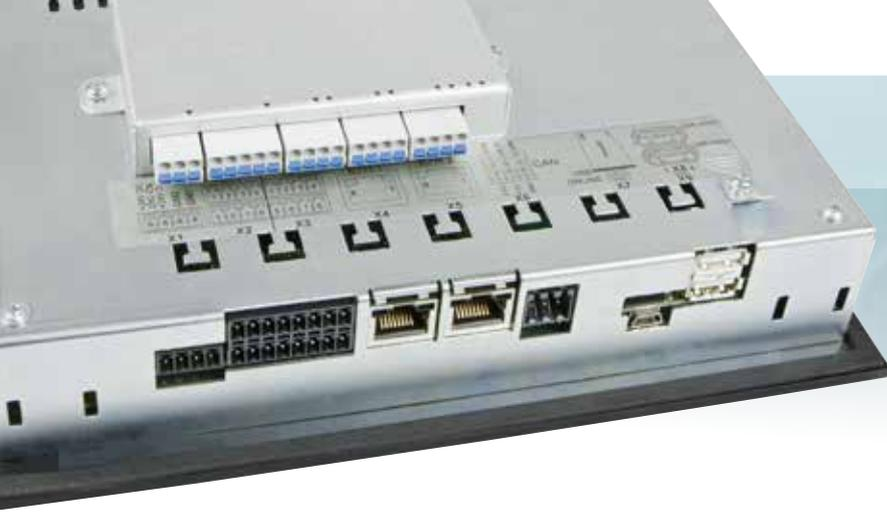
Bei den ETT-Panels sind die Schnittstellen nach unten ausgeführt. Die Safety Input Box SIB 061 mit 6 digitalen Safety-Eingängen zum dezentralen Einlesen von bis zu 3 Befehls- und Meldegeräten (2-kanalig) lässt sich einfach auf der Rückseite der ETTs montieren.
