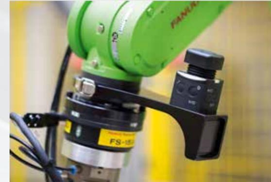
Indem Sie den kollaborativen FANUC Roboter durch Pfade und Punkte führen, können Sie ihn jetzt einfach anlernen. Darüber hinaus ist die Handführung komfortabel und intuitiv, so dass Sie kein Bediengerät mehr benötigen, um Roboterpositionen festzulegen. So sparen Sie nicht nur wertvolle Zeit, sondern auch Geld - denn die Schulungskosten können dadurch auf ein Minimum reduziert werden.
