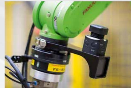
En le guidant selon des trajectoires ou des positions vous pouvez utiliser facilement votre robot collaboratif FANUC. Le guidage manuel est simple et intuitif éliminant ainsi la nécessité d'un boîtier d'apprentissage pour apprendre les positions. Vous gagnez ainsi un temps précieux, mais aussi de l'argent - car les coûts de formation peuvent ainsi être réduits.
