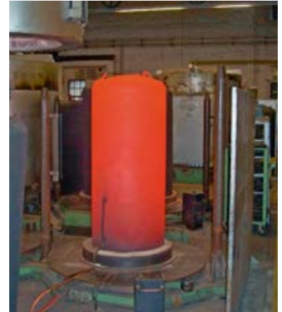
Haubenofen nach Abnahme der Heizhaube während der Abkühlphase
