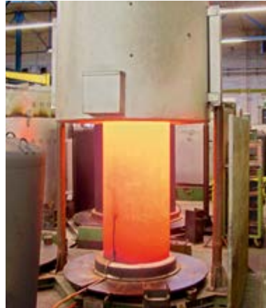
Haubenofen bei Abnahme der Heizhaube zum Start der Abkühlphase
