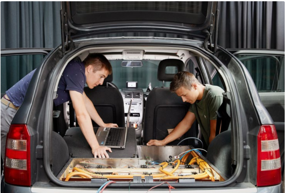
Retrofitting (Umbau) eines Audi A2 in ein Elektrofahrzeug.
