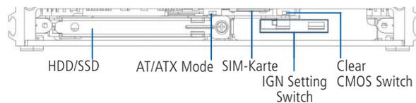
Serviceklappe zum einfachen Wechseln von SSD, SIM, zum Austausch von CMOS Batterie, zum Umschalten des Betriebsmodus
