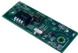
Power Ignition-Funktion, zeitgesteuertes Herunterfahren, ideal für KFZ-Anwendungen
