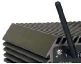
Integriertes mPCIe-Modul für Wireless Kommunikation (opt. WLAN/LTE/GPS...)
