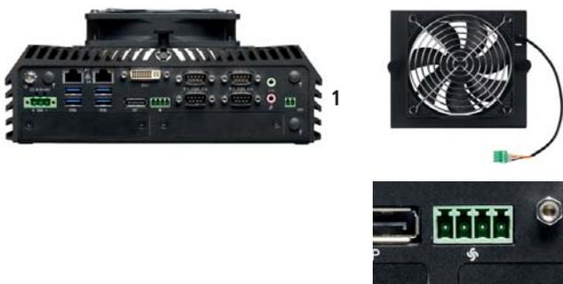
Externer PWM-Lüfter anschließbar um eine ausreichende Kühlung zu gewährleisten (empfohlen für Prozessoren über 35 W TPD)
