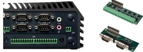
1 Low Speed Sockel für z.B. DIO, COM oder mPCIe Module
