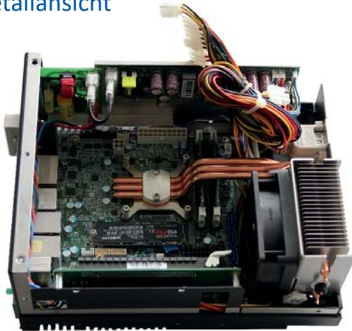
Ein drehzahl geregelter 80 mm Lüfter mit Heatpipe gewährleistet ein dauerhaft niedriges Temperaturniveau im Gehäuseinnern.
