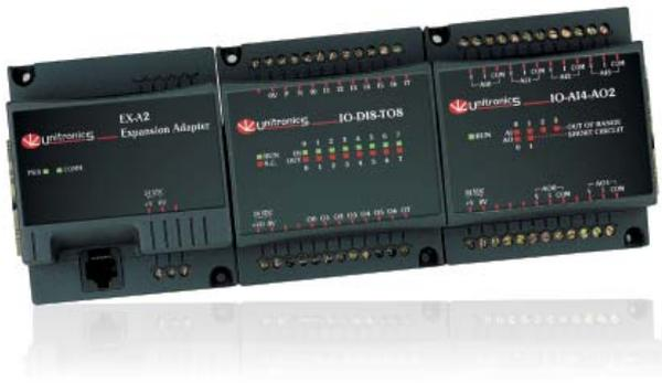
Wenn die onboard Ein-/Ausgänge der SPS nicht ausreichen, die E/A einige Meter entfernt sind oder auch für eine spätere Erweiterung, stehen dem Anwender zahlreiche E/A-Erweiterungsmodule zur Verfügung. Am Erweiterungsadapter können bis zu 8 E/A-Module (7 bei EX-Dxx) angeschlossen werden. Der Abstand zwischen den einzelnen Modulen wird durch das mitgelieferte Kabel auf wenige Zentimeter begrenzt. Die Verbindung zur SPS erfolgt über ein max. 30 m langes Kabel (Standard: 1 m)
