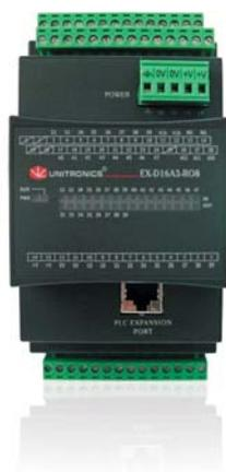
Bei allen Vision und M91 Modellen besteht die Möglichkeit, externe E/A als lokale E/A am Erweiterungsport des Controllers anzuschließen. Die Vision Controller können zusätzlich über CANbus auch mit weit entfernten Remote E/A erweitert werden. Lokale E/A (max. 8) werden über den E/A-Erweiterungsadapter EX-A2X oder ein E/A-Modul mit integriertem Adapter (EX-D16A3-x) und einem max. 20 m langen
